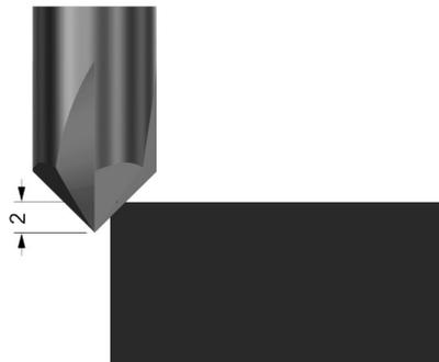
In den Werkzeugdaten sind unterschiedliche Durchmesser für die Konturverfolgung und die Simulation erforderlich.
