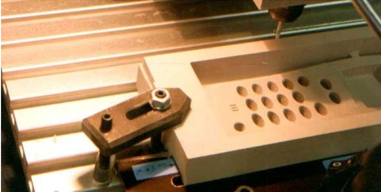
Bevor Sie die Klammern lösen, müssen Sie zunächst zwei Referenzflächen links und hinten bearbeiten, wie hier gezeigt. Aus diesem Grund wird auf der Rückseite des Blocks etwas Übermaß benötigt. Auch die linke Seite des Blocks muss etwas größer sein, damit etwas überschüssiges Material bearbeitet werden kann.
