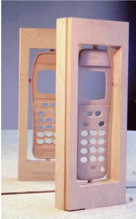
Die fertige Handschale direkt von der Maschine. Hier kann man gut die beiden Referenzflächen und die Stege erkennen. Der Rahmen und die Stege müssen von Hand entfernt werden. Etwas Schleifarbeit wird noch nötig sein dort wo die Stege waren.
