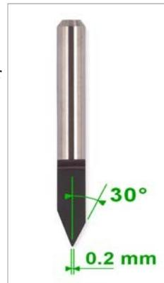
Beachten Sie den Unterschied zwischen dem „Schleifwinkel“ (in der Abbildung gezeigt) und dem „Spitzenwinkel“, den einige Fräserhersteller angeben. Für diesen Fräser beträgt dieser Winkel 60 Grad.
