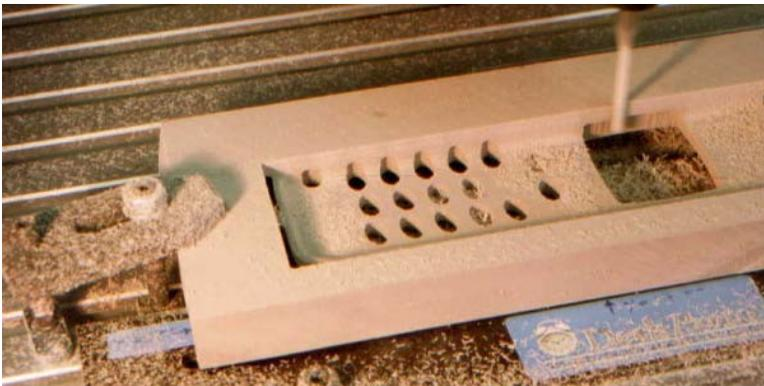
Die zweite Seite kann nun bearbeitet werden: Sie hat den selben Nullpunkt. Die Werkzeugwege passen genau.
