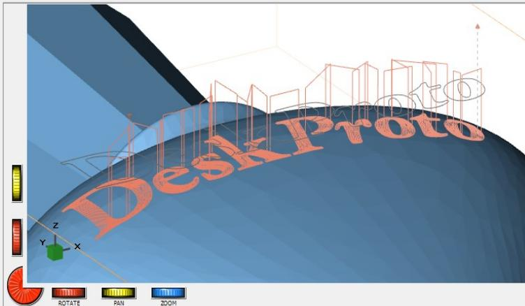
Im Bild oben wurde getrickst: Wir haben die Bearbeitungstiefe auf +0,1 mm eingestellt, um ein Bild mit sichtbaren Werkzeugwegen zu erstellen (diese Wege sind natürlich für die Bearbeitung nicht nützlich).
