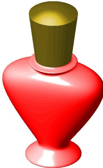
In dieser vierten Lektion erhalten Sie einen etwas tieferen Einblick in die Funktionalität von DeskProto. Es ist nicht möglich diese Geometrie von nur einer Seite zu erstellen. Die Flasche wird in zwei getrennten Hälften gefräst, welche anschließend zu einem kompletten Modell kombiniert werden (alternativ könnte eine Drehachse verwendet werden, siehe folgende Lektionen). Diese Lektion ist für alle DeskProto Editionen und verwendet die dialogbasierte Oberfläche.
