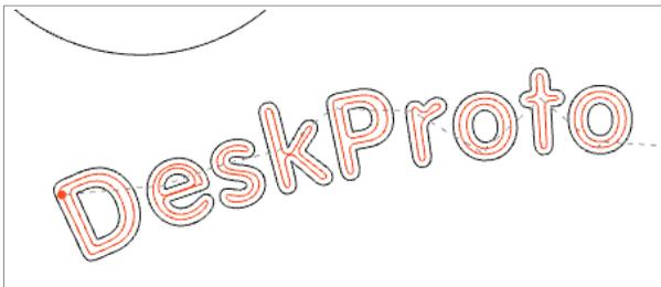
Die gestrichelten Linien in Grau sind Positionierbewegungen auf der Höhe des Sicherheitsabstand. Nachdem Sie beide Dialogfelder geschlossen und erneut auf Werkzeugwege berechnen geklickt haben, werden auf dem DeskProto Bildschirm die Werkzeugwege für beide Operationen angezeigt:
