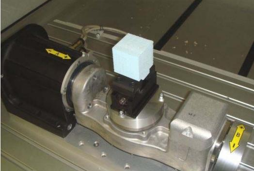
Die Anordnung der Achsen auf dieser Maschine entspricht nicht dem Standard. Die lange Achse ist die B-Achse, welche bei dieser Maschine parallel zur X-Achse ist. Die Runde Plattform kann rotieren und ist die A-Achse: in dieser Orientierung ist ( $B=0$ ) sie parallel zu Z (wäre also die C-Achse). A und B Rotation um 90 Grad lässt die Achse parallel zur Y Achse sein. So hat die Fräse natürlich eine A und B Achse, nur das diese vertauscht sind (im Vergleich zu DeskProto und der Standardkonvention).
