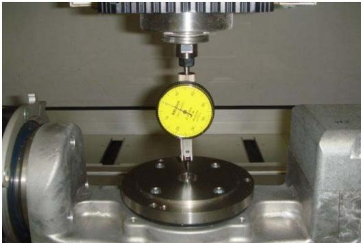
Der erste Schritt bestand darin, den Werkstück-Nullpunkt sehr genau einzustellen. Mit der Spitze des Fräasers genau an der Stelle, an der sich die A-Achse und die B-Achse schneiden. Diese Lektion zeigt nicht, wie das genau gemacht wird. Sie können entweder mit einem Messgerät wie auf dem Foto gezeigt messen oder ein Probenzylinder mit einem grob eingestellten Nullpunkt bearbeiten, das Ergebnis messen und den Nullpunkt nach Bedarf korrigieren.
