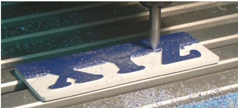
Für diesen Job sind die Schnittkräfte sehr gering, sodass wir das Rohteil mit doppelseitigem Klebeband problemlos auf dem Maschinentisch befestigen können. Achten Sie bei der Verwendung von Klammern, eines Maschinenschraubstocks oder Ähnlichem darauf, dass der Fräser nicht damit kollidiert.
