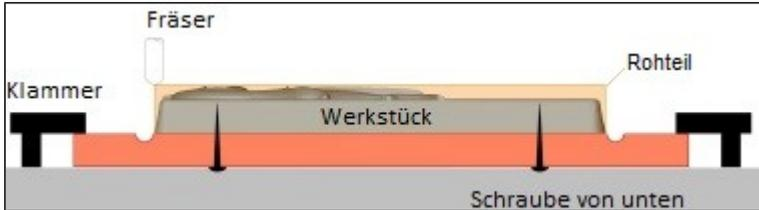
Diese Schraubmethode funktioniert sehr gut. So können weiterhin Klammern zur Fixierung verwendet werden ohne diese zu beschädigen. Sie müssen nur darauf achten das Sie die Schrauben richtig positionieren damit sie nicht weg gefräst werden. Das Opferplatte wird nach der Bearbeitung beschädigt sein, da der Fräser etwas tiefer als die Unterkante des Bilderrahmens fräst. Auf der Webseite [www.DeskProto.com](http://www.DeskProto.com) finden Sie ein Tutorial Video zur Demonstration.
