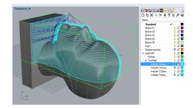
Nun wird die Rückseite bearbeitet, hierzu müssen wir unter **4-Achsen Einstellungen Bearbeiten, Drunter** wählen.
