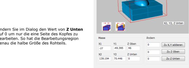
Ändern Sie im Dialog den Wert von **Z Unten** auf 0 um nur die eine Seite des Kopfes zu bearbeiten. So hat die Bearbeitungsregion genau die halbe Größe des Rohteils.
