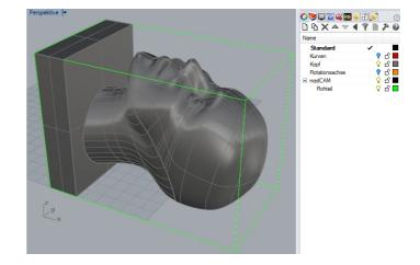
Klicken Sie auf **Werkzeug einfügen oder bearbeiten**. Wählen Sie den Fräser **Flach\_8** und drücken Sie **OK**. Dieser Fräser hat unter Verwendung der Voreinstellungen eine Länge von 50mm, dies sollte ausreichen damit das Spannfutter des Fräsers nicht an den Fuß stößt.
