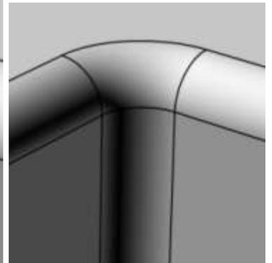
Rundung ist ein Bereich komplexer Berechnungen. Orte mit kleinen, zersplitterten Oberflächen, oder viele Kanten, die an einen gemeinsamen Punkt enden, erhöhen die Chance, dass die Berechnung für das Abrunden fehl schlägt. Es kann daher helfen, Dinge mit breiteren Oberflächen und mit simplen Eckstrukturen zu modellieren.
