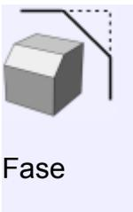
Bei Fase werden scharfe Kanten/Ecken mittels eines glatten kleinen Teils "abgehackt".
