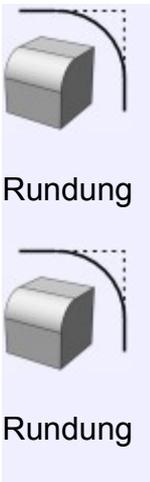
Rundung wird für das Abrunden von scharfen Ecken/Kanten verwendet.
