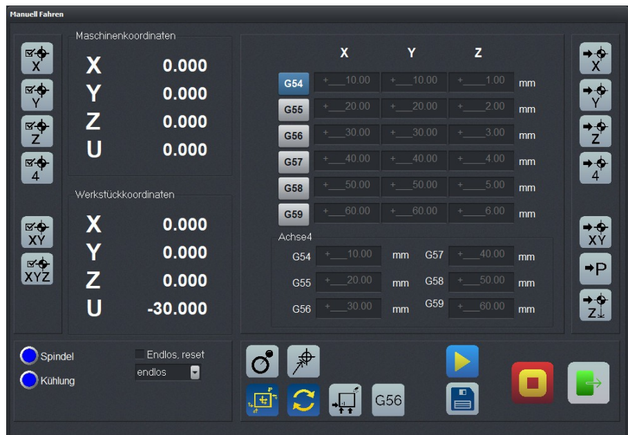
Arbeiten mit mehreren Nullpunkten (G54..G59)
