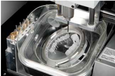
5-Achs Maschine 1 (Roland DWX-50, für Zahnimplantate).
