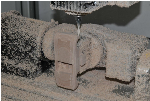
Hier das Schruppen auf der Maschine.
